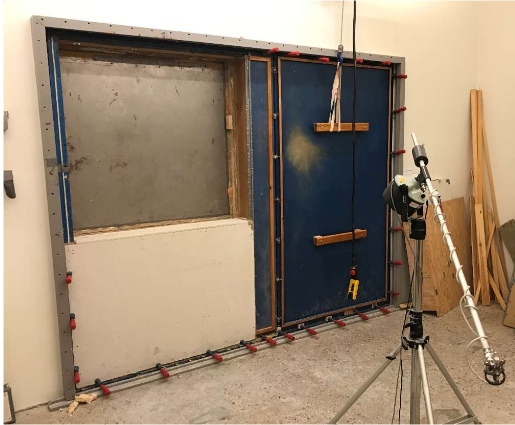
Figur 1: Den kvadratiska enkelväggskonstruktionen av stålplåt i den variabla provöppningen, sedd från sändarrummet vid monteretillfället.
