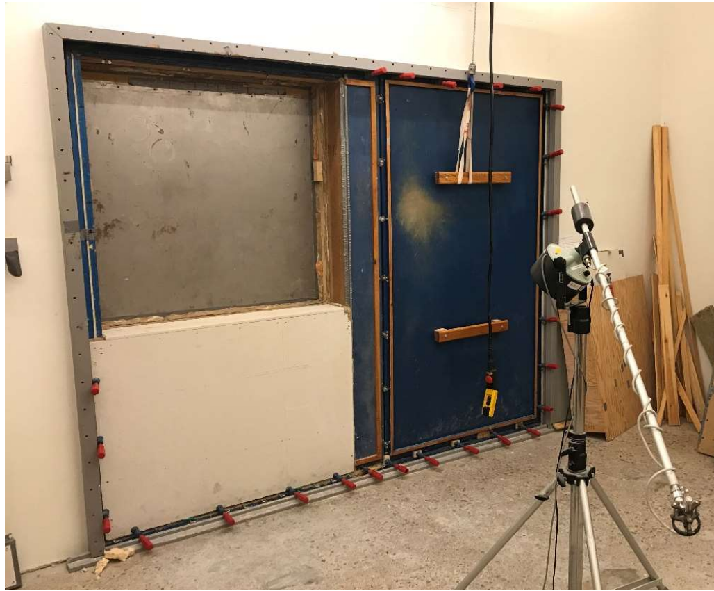
Figur 1: Den kvadratiska enkelväggskonstruktionen av stålplåt i den variabla provöppningen, sedd från sändarrummet vid montage tillfället.
